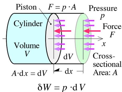
力  $F$  の作用でピストンは距離  $dx$  [m] だけ押し込まれ, このとき外部から仕事  $\delta W = F \cdot dx = p \cdot A \cdot dx$  [N·m]=[J] が気体に与えられる. ピストンが  $dx$  押し込まれて, 気体の容積は  $dV = A \cdot dx$  [m<sup>3</sup>] だけ小さくなった. すなわち, 力  $F$  [N] が付与されて,
